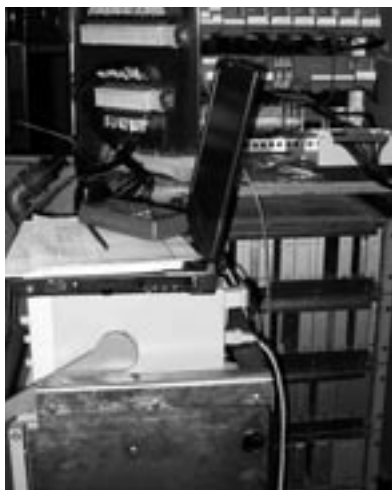
Testaufbau der Inbetriebnahme mit alter Elektronik (unten), neuer Elektronik (oben), Laptop und KO (vorne)
