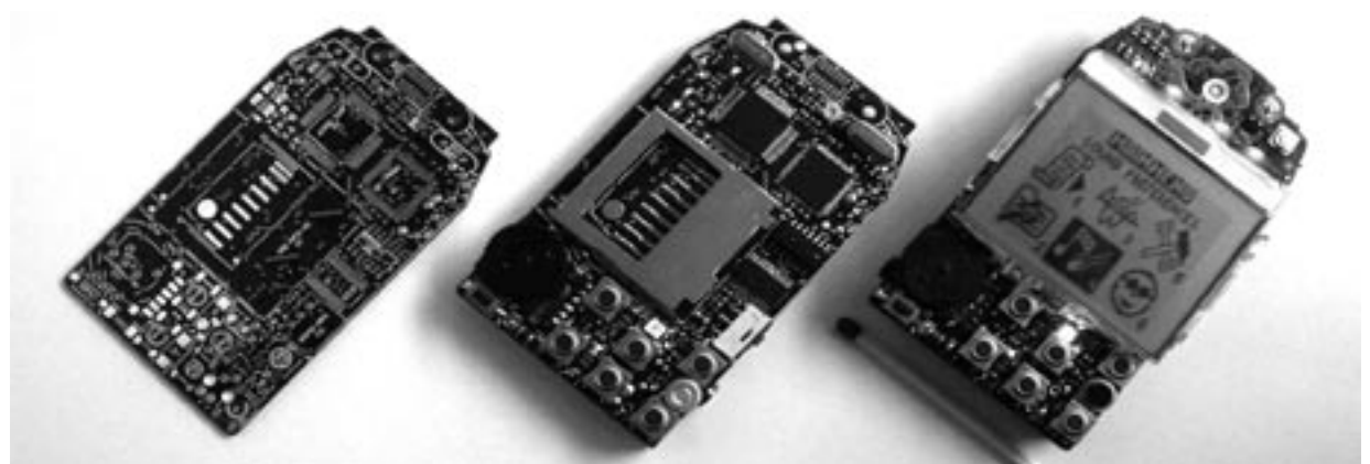
Unser MP3-Recorder unbestückt, bestückt ohne Display und in der "Endversion" (noch ohne Gehäuse) (v.l.n.r.). Als Grössenvergleich dient hier ein Streichholz.
