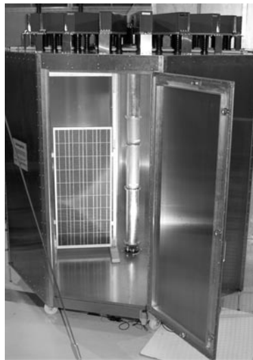
Stossstromgenerator mit einem zu Testzwecken montierten Solarmodul
