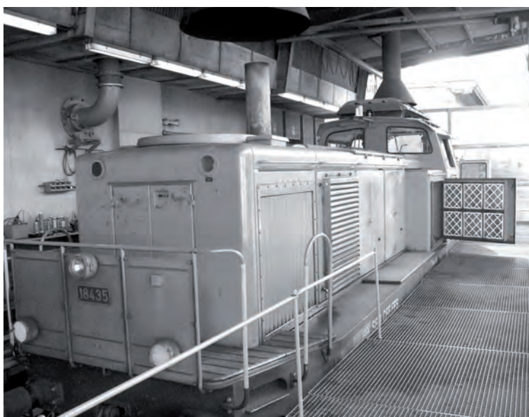
Bm 4/4 auf dem Prüfstand des IW Biel
