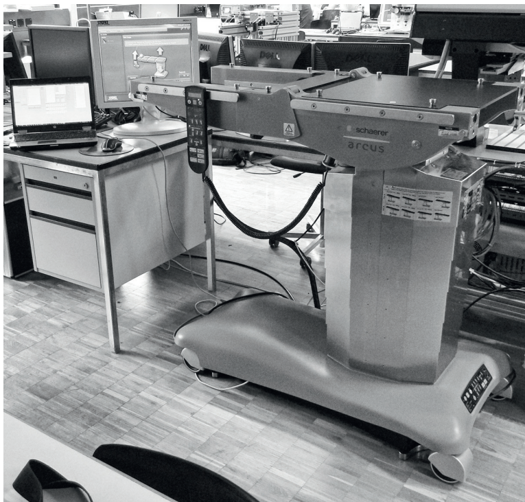
Testaufbau des Systems bestehend aus OR1, Protokollkonverter und ARCUS
