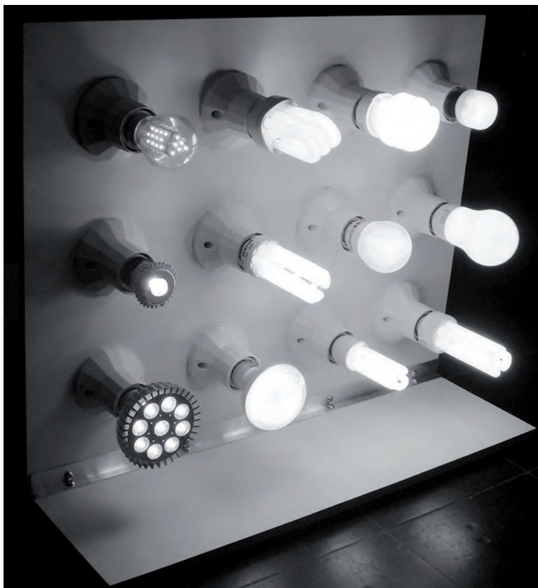
Alterung der Lampen zur normgerechten Messung
