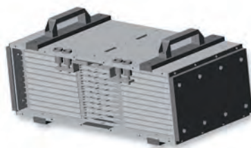
Zellenstack des Batteriekonzeptes für Itaipu
