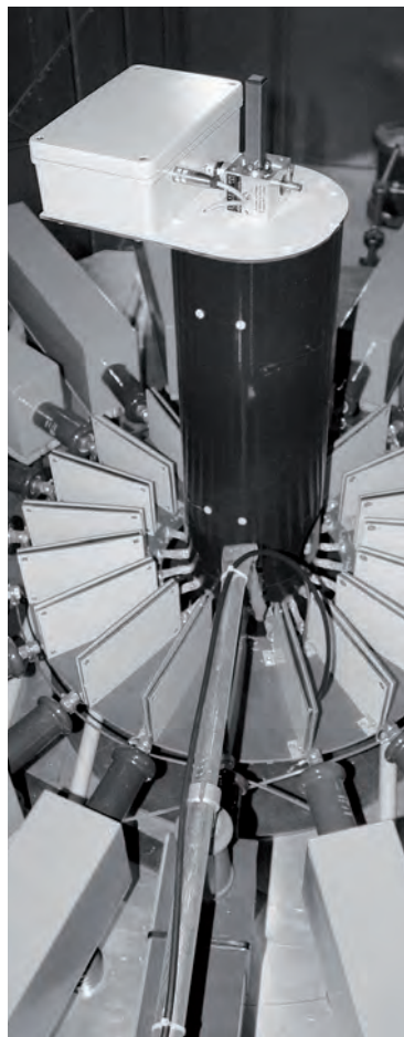
Bild 2: Motor auf Stossstromgenerator
