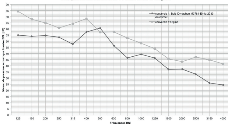
Comparaison du SPL entre la construction actuelle de la cloison moteur et du concept de remplacement numéro 1
