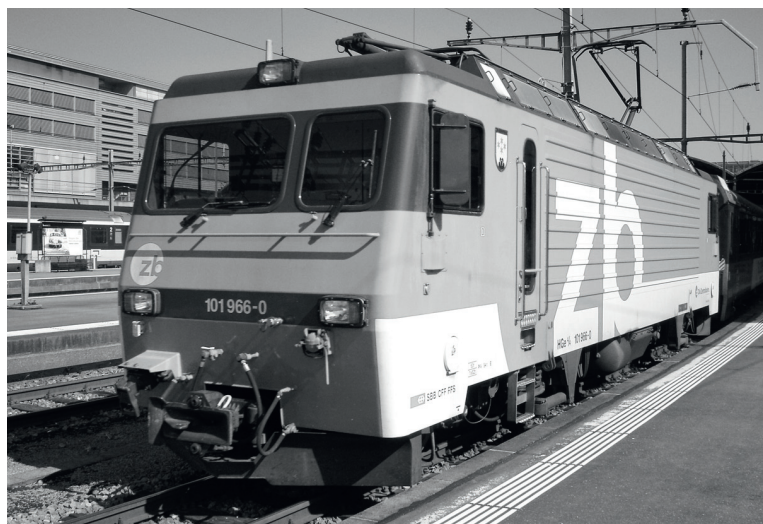
Lokomotive vom Typ HGe101 der Zentralbahn
