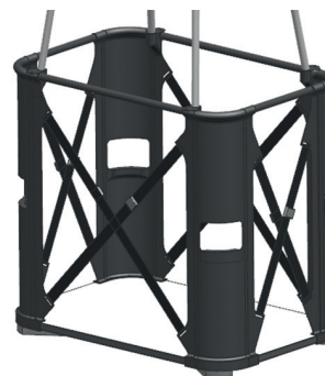
Rahmen des Ballonkorb-Konzeptes aus kohlefaserverstärkten Kunststoff-Profilen (CFK)
