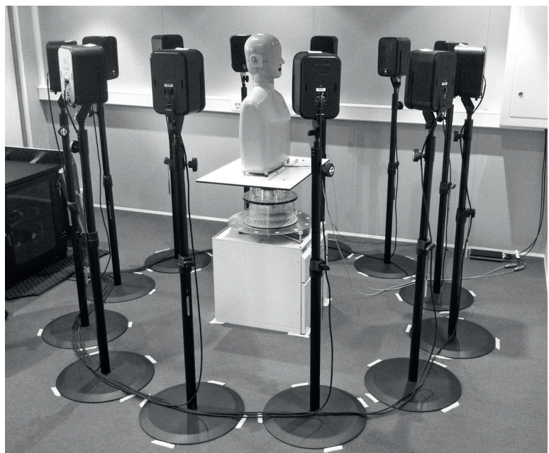
Messaufbau mit den zwölf Lautsprechern und dem Messkunstkopf in der Acoustic Chamber des Inselspitals Bern
