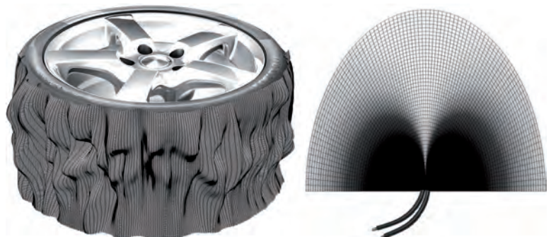
Gauche: Champ magnétique généré par un pneu de voiture
