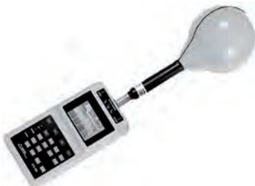
Instrument de mesures de champs magnétiques NARDA EFA-300
