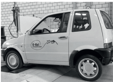
Le véhicule de laboratoire WBO sur le banc d'essai à rouleaux
