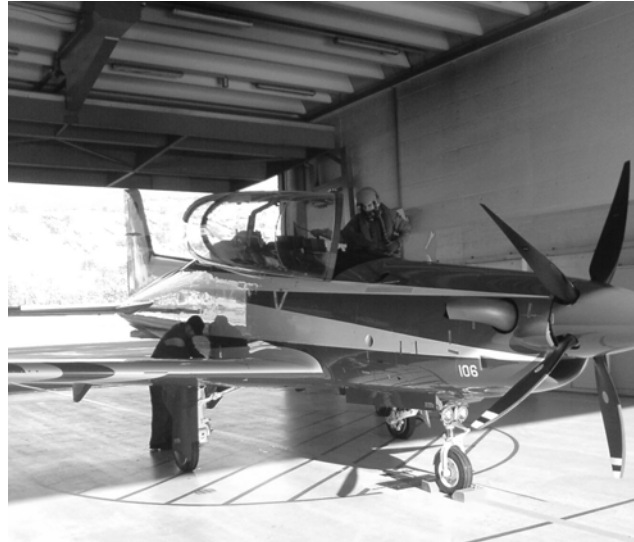
Unmittelbar nach dem Einsatz werden die Beanspruchungsdaten der Pilatus PC-21 der Luftwaffe zum Festlegen von Wartungsmaßnahmen erhoben.
