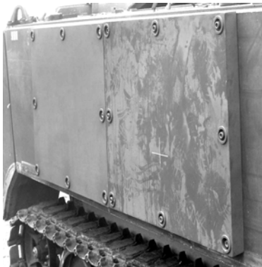
Zwei „SidePro-EFP“ Schutzmodule montiert auf einem M113 als Prototyp. Durchschlagsleistung vierzig Millimeter Panzerstahl
